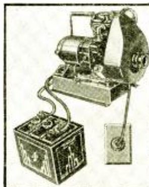
A 300-W. power plant. (1109)
